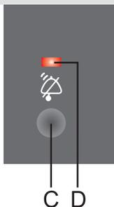
При превышении допустимой температуры включается **прерывистый звуковой сигнал** и мигает лампочка **Д**. Лампочка автоматически погаснет, когда температура в морозильнике достигнет уровня, при котором нет опасности порчи продуктов.
