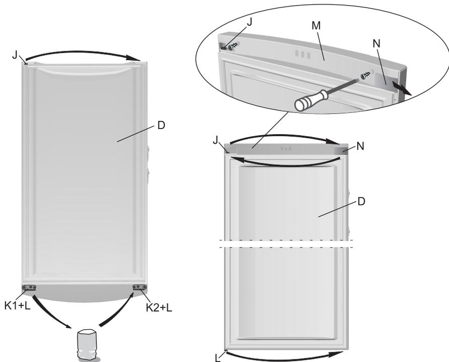
4. **ИСПОЛНЕНИЕ I: дверца D:** Переставьте втулку J на противоположную сторону. Снимите ограничитель открывания дверцы K1 с подшипником L, с противоположной стороны установите ограничитель открывания дверцы K2, который с подшипником L прилагается в комплекте.
