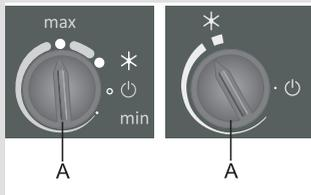
Поверните переключатель **A** по часовой стрелке в область, обозначенную толстой линией.
