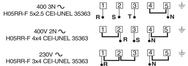
Порядок подсоединения кабеля электропитания:
