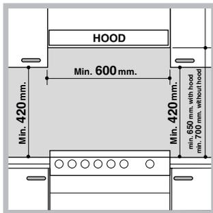
• если кухонная плита устанавливается под навесным шкафом, он должен располагаться на высоте не менее 420 мм от поверхности варочной панели. Это расстояние должно быть 700 мм, если материалы шкафы выполнены из возгораемого не (см. рисунок);
