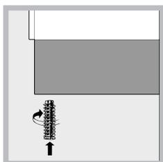
При необходимости покрутите по выровнять изделие кухонной в специальные отверстия углам в основании плиты прилагающиеся регулиционные ножки\* по (см. рисунок).
