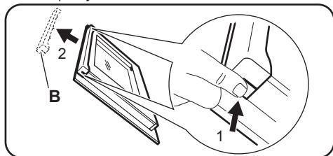
3. Чтобы снять дверную планку, потянните ее вперед.
