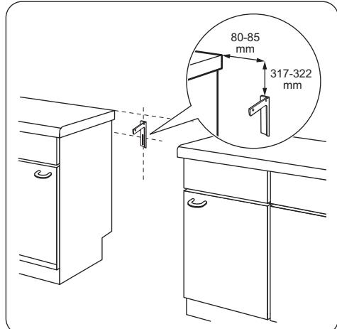
2. Отверстие для крепления находится слева на задней стороне прибора. Поднимите переднюю часть прибора и поместите его между кухонными шкафами. Если расстояние между кухонными шкафами больше, чем ширина прибора, следует установить его так, чтобы зазоры с обеих сторон были одинаковыми.
