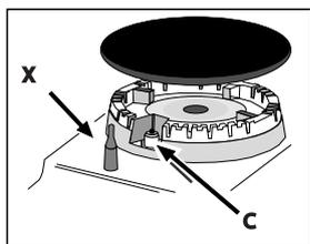
Если изделие оснащено электронной системой зажигания\* (см. рисунок), вначале нажмите кнопку зажигания, обозначенную символом
