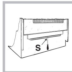
Отвинтите винт S и снимите выдвижную панель (см. рисунок). Для ее обратной установки завинтите винт S.
