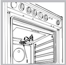
2. отвинтите форсунку горелки гриля при помощи специального полого ключа для форсунок (см. рисунок) или, что предпочтительнее, при помощи полого ключа 7 мм и замените форсунку на новую, рассчитанную на
