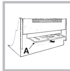
Модели газовых кухонных плит оснащены выдвижной панелью А для предохранения нижнего отсека от тепла, выделяемого горелкой (см. рисунок).
