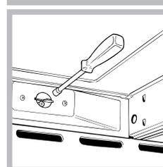
4. отвинтите форсунку горелки при помощи специального полого ключа для форсунок (см. рисунок) или полого ключа 7 мм и замените форсунку на новую, рассчитанную на новый тип газа (см. таблицу Характеристики горелок и форсунок).
