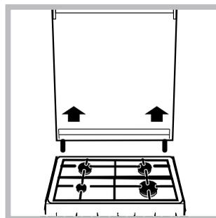
Если модель вашего изделия оснащена стеклянной крышкой, мойте ее теплой водой. Избегайте использования абразивных средств. Крышку можно снять для облегчения чистки задней части варочной панели. полностью откройте крышку и потяните ее вверх (см. рисунок).
