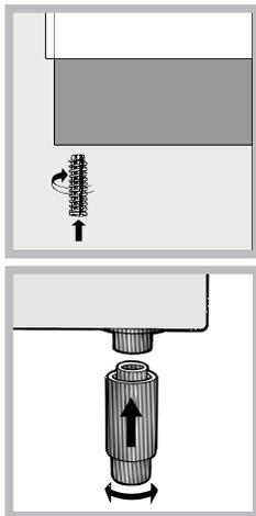
При необходимости выровнять изделие вкрутите в специальные отверстия по углам в основании кухонной плиты прилагающиеся регулировочные ножки (см. рисунок).
