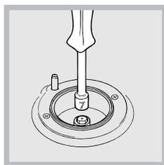
2. отвинтите форсунки при помощи полого гаечного ключа 7 мм (см. рисунок) и замените их на форсунки, рассчитанные на новый тип газа (см. таблицу Характеристики горелок и форсунок);
