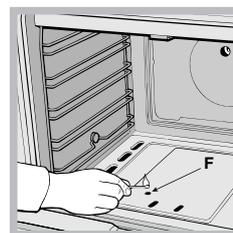
к отверстию F (см. рисунок) зажженную спичку или кухонную зажигалку, нажмите и одновременно поверните против часовой стрелки рукоятку ДУХОВКИ в положение МАКС.
