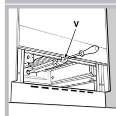
3. выньте горелку из духового шкафа, сняв V-образный винт (см. рисунок); выполнение этой операции можно облегчить, сняв дверцу духового шкафа.
