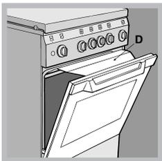
! Когда вы используете гриль, необходимо оставить дверцу духового шкафа полуоткрытой, установив между дверцей и панелью управления отражатель D (см. рисунок), препятствующий нагреванию рукояток.
