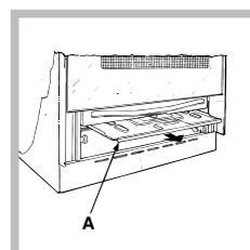
2. снимите выдвигающую панель A (см. рисунок);
