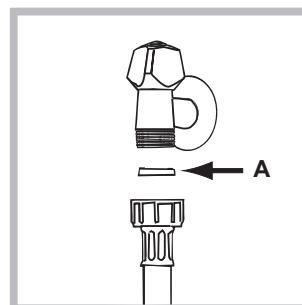
1. Підключіти живлячий трубопровід, прикрутивши його до крану холодної води за допомогою штуцеру з газовою різьбою 3/4 (див. малюнок). Перед підключенням спустіть воду, доки вона не стане прозорою.
