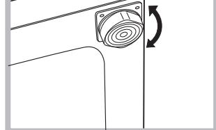
Належне вирівнювання надає стабільність машині та запобігає вібрації, шуму та пересуванню під час роботи. При встановленні машини на килимовому покрівлі або килимі відрегулюйте ніжки таким чином, щоб залишити під пральною машину достатній простір для вентиляції.
