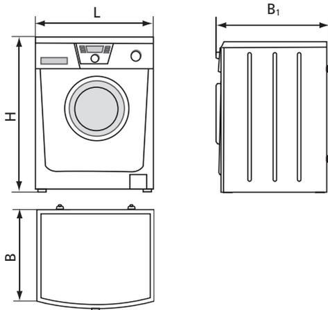
H - высота, L - ширина, B - глубина по корпусу, B<sub>1</sub> - глубина
