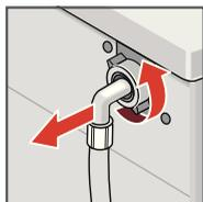
Снимите шланг со спинки прибора.
