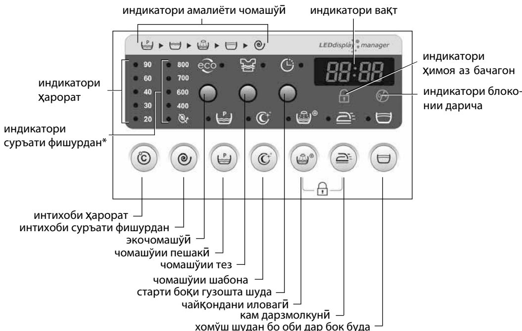
Расми 3 – Зонаҳои индикатсия ва тугмаҳои интиҳоби функсияҳои иловагӣ
