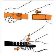
Соедините металлическую телескопическую трубу с ручкой шланга. Все насадки могут быть установлены на конце металлической телескопической трубы.
