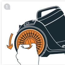
Постмоторный фильтр располагается в левом колесе. Удерживайте центр колеса и поверните крышку фильтра против часовой стрелки.
