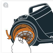
После снятия крышки фильтра вы легко сможете извлечь постмоторный фильтр.
