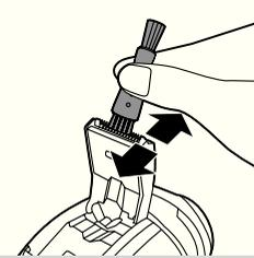
**3** Почистити тример можна за допомогою щітки для чищення, використовуючи сторону з короткою щетиною. Проводьте щіточкою вгору-вниз вздовж зубців тримера.
