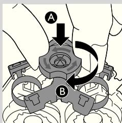
**7** Umístěte zajišťovací rámeček zpět do holicí jednotky (A) a otočte pojistku ve směru hodinových ruček (B).
