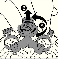
**4** Zaklep obrnite v levo (A) in odstranite nosilni okvir (B).
