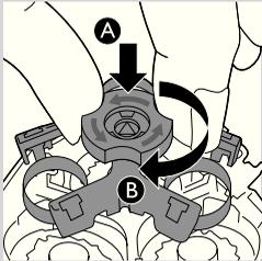
**7** Następnie załóż element zabezpieczający na moduł golący (A) i obróć blokadą (B) w prawo.
