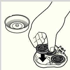
**6** Vložte holicí hlavy zpět do holicí jednotky.
