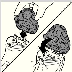
**8** Вставте виступ бритвеного блока у виїмку на верхній частині бритви, після чого закрийте його.
