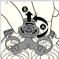
**4** Поверните фиксатор против часовой стрелки (A) и снимите крепежную рамку (B).
