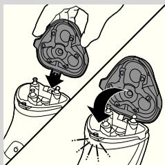
**8** Vložte výstupek nové holicí jednotky do zářezu v horní části holicího strojeku. Potom holicí jednotku zavřete.
