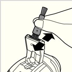
*Sugestie: Pentru a garanta performanțe optime de tundere, ungeți dinții dispozitivului de tundere cu puțin ulei pentru mașina de cusut o dată la șase luni.*
