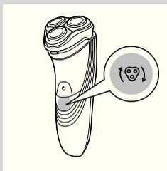
Aby byl zajištěn maximální holicí výkon, doporučujeme holicí hlavy vyměnit každé dva roky.
