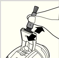
**3** Почистете машинката за подстригване, като използвате края с къси косми на четката за почистване. Четкайте нагоре и надолу успоредно на зъбите на машинката.
