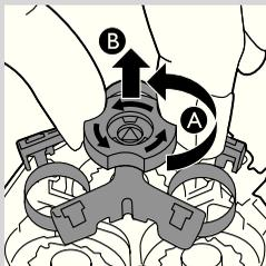
**4** Otočte pojistku směrem doleva (A) a vyjměte zajišťovací rámeček (B).
