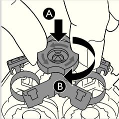
**7** Vratite granični okvir u jedinicu za brijanje (A) i okrenite bravu u pravcu kretanja kazaljki na satu (B).
