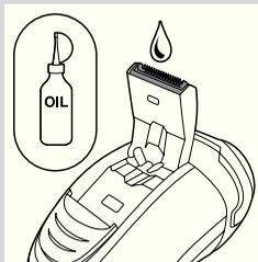
*Tip: Aby byl zajištěn optimální výkon při zastříhování, kápněte na zuby zastříhovače jednou za šest měsíců kapku oleje na šicí stroje.*
