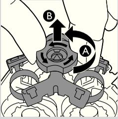
**5** Поверните фиксатор против часовой стрелки (А) и снимите крепежную рамку (В).
