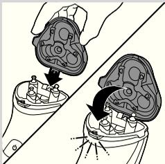
**8** Ubacite ušicu jedinice za brijanje u prorez na vrhu aparata za brijanje. Zatim zatvorite jedinicu za brijanje.
