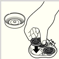
**6** Vyjměte holicí hlavy a do holicí jednotky vložte nové hlavy.
