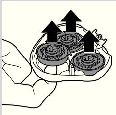
**5** Holicí hlavy čistěte vždy po jedné. Každá holicí hlava se skládá z nožového věnce a holicí korunky.
