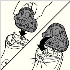
**8** Umieść wypstę elementu golącego w szczelinie w górnej części golarzki. Następnie zamknij element golący.
