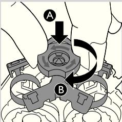
**7** Установите крепежную рамку в бритвенный блок (А) и поверните фиксатор по часовой стрелке (В).
