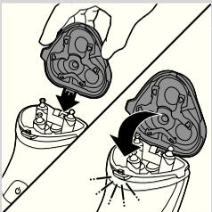
**8** Umieść wypstę nowego elementu golącego w szczelinie w górnej części golarki. Następnie zamknij element golący.
