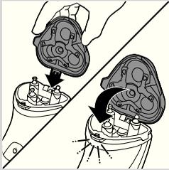
**8** Вставьте выступ бритвенного блока в паз в верхней части бритвы, затем закройте бритвенный блок.
