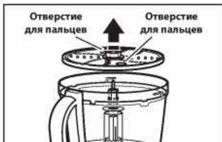
4 Чтобы вынуть шинковальный диск и диск для нарезки картофеля фри, используйте отверстия для пальцев и поднимайте диск.
