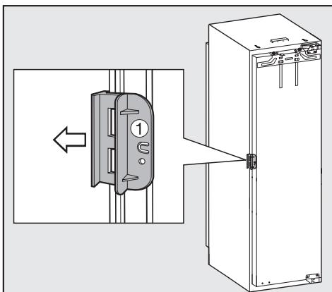
■ Откройте дверцу прибора и снимите красную транспортную блокировку ① (в зависимости от модели).
