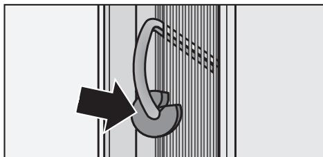
– распорку (в зависимости от модели). Она обеспечивает требуемое расстояние между задней стороной прибора и стеной.
