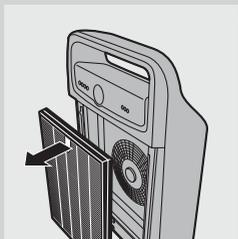
**6** Чтобы извлечь фильтр 4 (фильтр HEPA), возьмитесь за ярлык на панели фильтра и потяните на себя.
