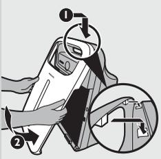
**12** Чтобы установить на место переднюю панель, сначала вставьте в верхнюю часть прибора два верхних крючка (1). Затем прижмите панель к корпусу прибора (2).
