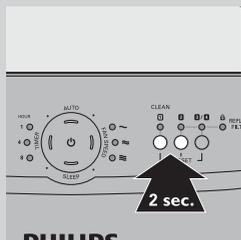
глазу частицы размером более 20 нанометров, включая бактерии и некоторые вирусы. В соответствии с данными ВОЗ, размер вирусов птичьего гриппа, гриппа человека и легионеллы больше 20 нанометров. После установки NANOфильтра необходимо включить индикацию замены фильтра 2:
