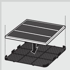
**7** Только для модели AC4004: прикрепите фильтр 2 (NANOфильтр) к задней поверхности фильтра 1 (фильтр предварительной очистки).
