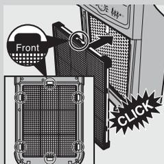
**8** Установите в прибор фильтр 1 (фильтр предварительной очистки).
