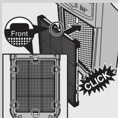
**11** Установите в прибор фильтр 1 (фильтр предварительной очистки).
