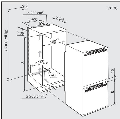
Перед встраиванием убедитесь, что шкаф для встраивания точно соответствует приведенным размерам для встраивания. Для корректной работы прибора должны быть обязательно соблюдены приведенные сечения вентиляционных отверстий.
