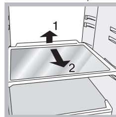
Elles sont amovibles et réglables en hauteur grâce à des glissières spéciales (voir figure), pour le rangement de récipients ou d'aliments de grande dimension. Pour régler la hauteur, pas besoin de sortir la clayette complètement.
