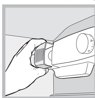
Sostituirla con una analoga di potenza a quella indicata sulla protezione (15 W o 25 W).
