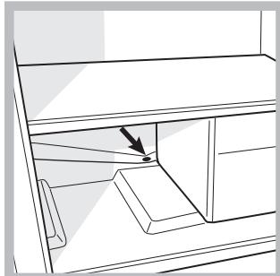
El frigorífico posee descongelación automática: el agua se envía hacia la parte posterior por un orificio de descarga (ver la figura) donde el calor producido por el compresor la hace evaporar. La única intervención que se debe realizar periódicamente consiste en limpiar el orificio de descarga para que el agua pueda fluir libremente.
