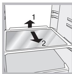
**DRAAGPLATEAU:** plateaus of roosters. Deze kunnen dankzij de speciale glijden worden verwijderd of in hoogte geregeld (zie afbeelding), voor het invoeren van grote verpakkingen of etenswaren. Het is niet noodzakelijk het draagplateau volledig te verwijderen om de hoogte te regelen.
