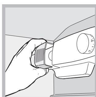
Acceda a la lámpara quitando la protección como se indica en la figura. Sustitúyala con otra bombilla con una potencia igual a la indicada en la protección (15 W o 25 W).
