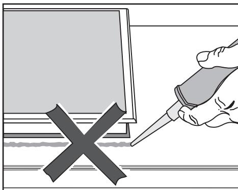
Уплотнитель под кромкой верхней части прибора обеспечивает необходимую герметичность между прибором и столешницей.
