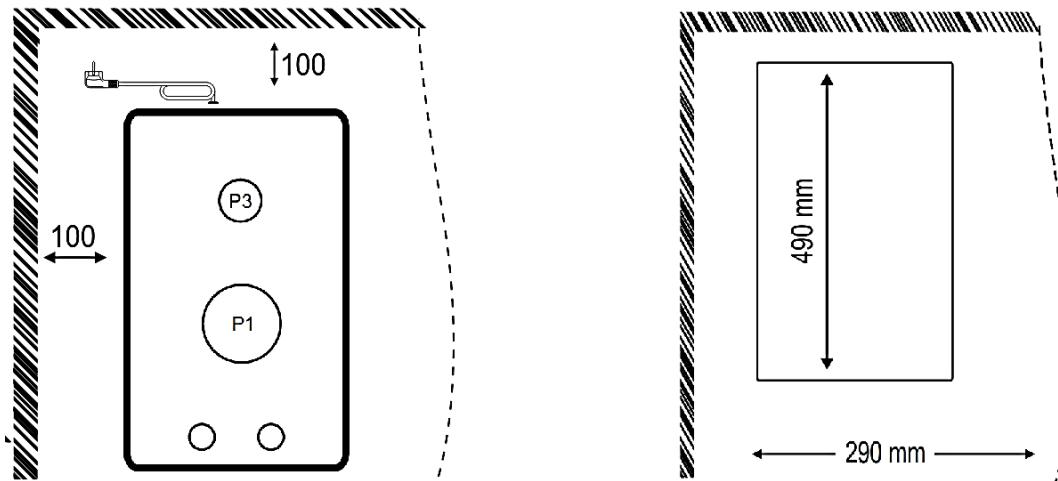
Внешние размеры, указанные цифрами, определяют стандартные размеры плиты на столешнице. После того, как столешница подготовлена, обратитесь в обслуживающий центр для установки плиты. Позвоните в уполномоченный сервисный центр.
