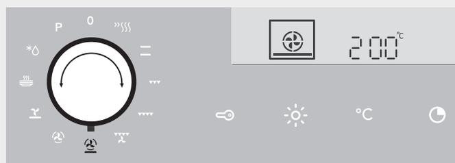
**3** Поверните ПЕРЕКЛЮЧАТЕЛЬ РЕЖИМА НАГРЕВА в положение «Нагрев снизу + вентиляционный нагрев». На дисплее загорятся символы режима нагрева и подключенного зонда, предустановленная температура духовки и температура зонда. Нажмите на сенсор СТАРТ/СТОП.
