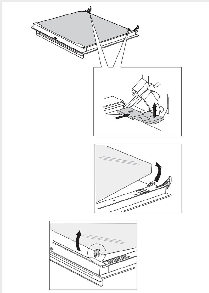
**1** Немного приподнимите фиксаторы с левой и правой стороны дверцы (символ 1 на фиксаторе) и потяните в стороны от стекла (символ 2 на фиксаторе).
