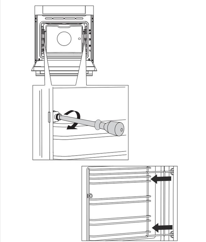
**1** Открутите винт с помощью отвертки.
