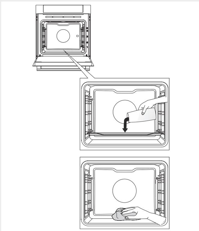
**1** Поверните ПЕРЕКЛЮЧАТЕЛЬ РЕЖИМА НАГРЕВА в положение AquaClean. На дисплее загорятся символ режима нагрева, ПРЕДУСТАНОВЛЕННАЯ ТЕМПЕРАТУРА и время 30 минут.
