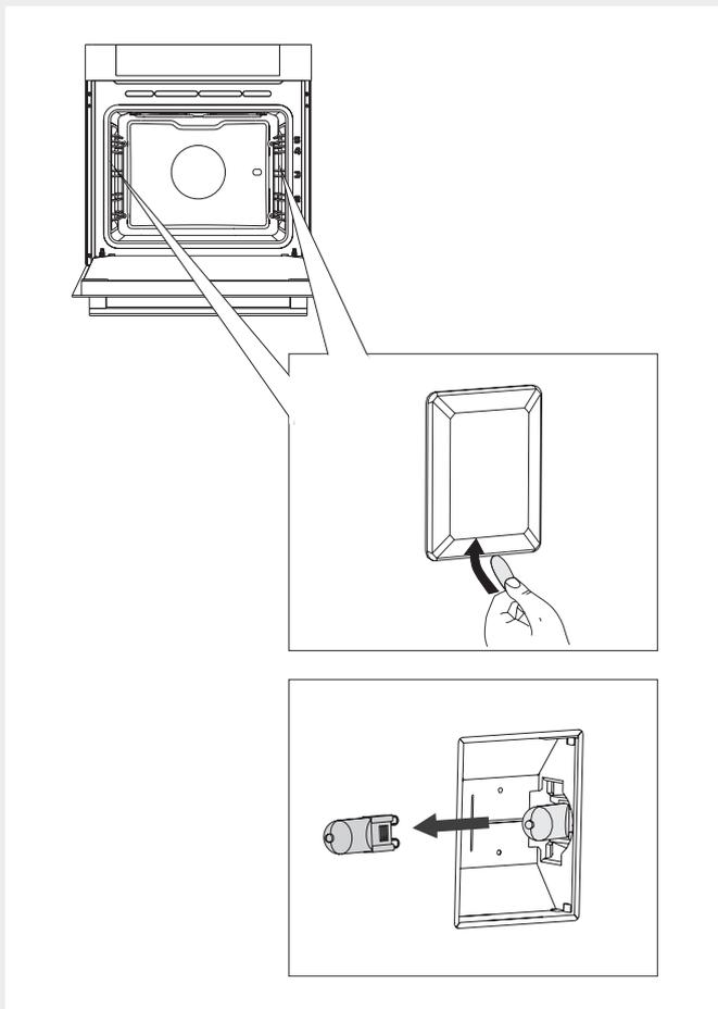
**1** С помощью отвертки снимите крышку.
