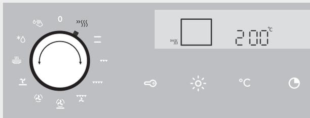
Установите переключатель РЕЖИМА НАГРЕВА в положение «Размораживание».
