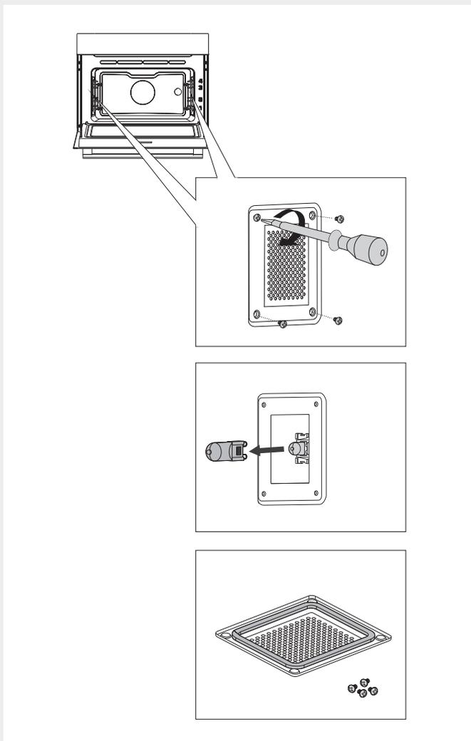
**1** Открутите четыре винта на крышке. Снимите крышку и стекло.
