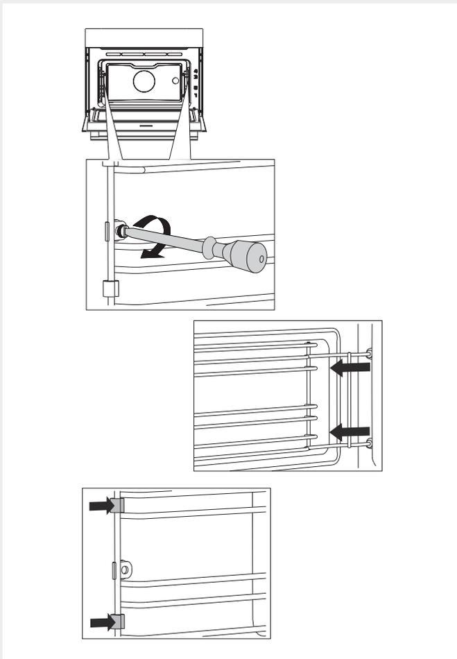
**1** Открутите винты с помощью отвертки.
