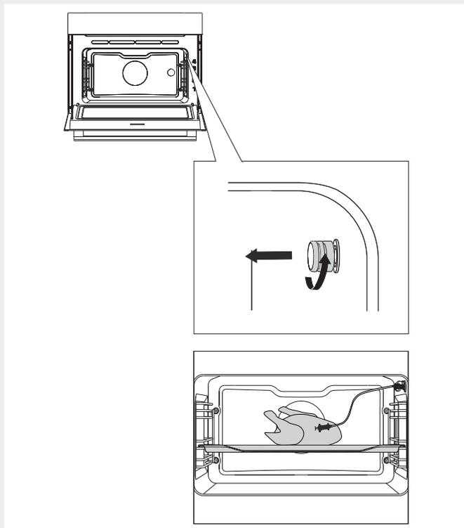
**1** Выньте металлическую заглушку (гнездо для зонда расположено в переднем верхнем углу на правой стенке духовки).
