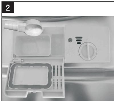
Открыть емкость для моющего средства, нажимая кнопку (Рис. 1). Заполнить емкость моющим средством (с помощью специальной ложечки - Рис. 2). Отметки внутри емкости помогают определить соответствующее количество моющего средства. Общий объем емкости для моющего средства составляет 25 г моющего средства.
