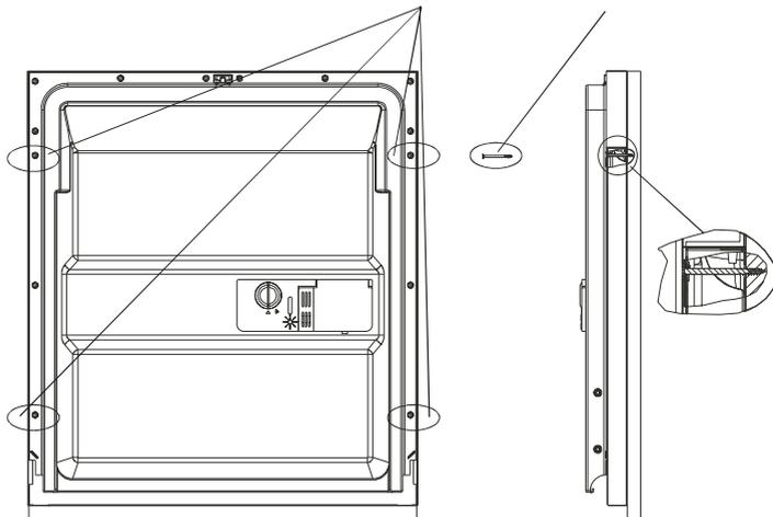
• Регуляция натяжения дверной пружины
