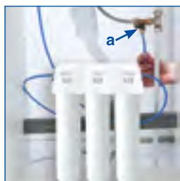
**13.** Удалив стопорную клипсу, вставьте подводящую трубку (а) в узел подключения до упора. Установите клипсу на место
