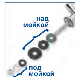
6. Наденьте на резьбовой хвостовик крана декоративную подставку, резиновую прокладку и резиновую шайбу
