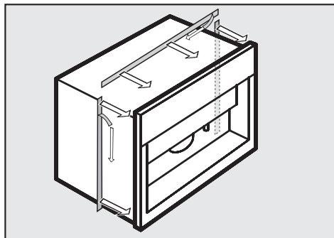
■ Если спереди в нише для встраивания нет уплотнения по краю, то наклейте перед встраиванием сзади прибора уплотнительные полоски Miele.
