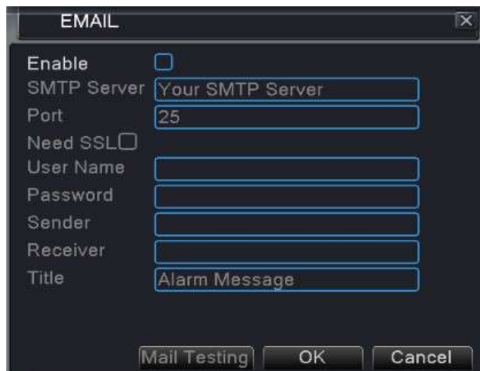
Рис. 4.19 Настройка электронной почты
