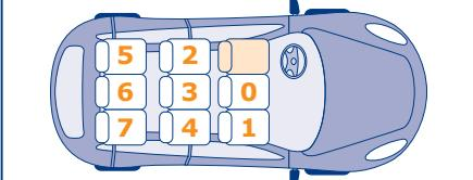
NON INSTALLARE CON VANO PORTAOGETTI SUL PAVIMENTO DELL'AUTO.
